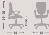
MX33 Poltrona dattilo ergonomica alta con braccioli regolabili mov. 4. High ergonomic typing adjustable armchair mov. 4.
